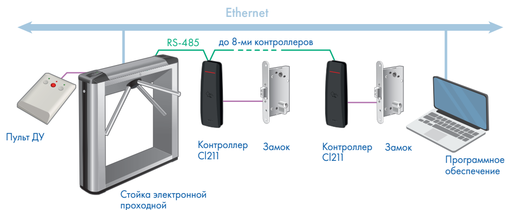
Структурная схема подключения электронной проходной
